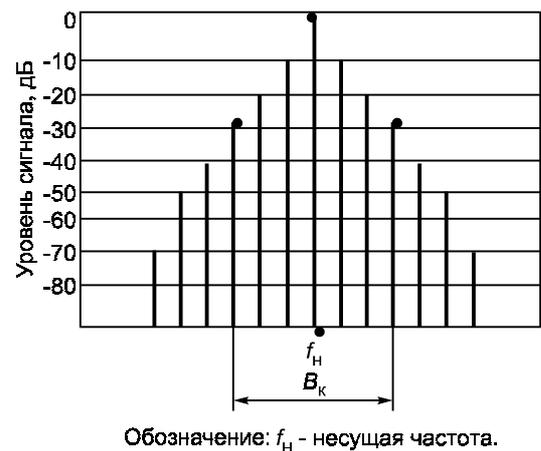
Рисунок 21 — Отсчет контрольной ширины полосы частот  $B_k$  на экране анализатора спектра с логарифмическим детектором
