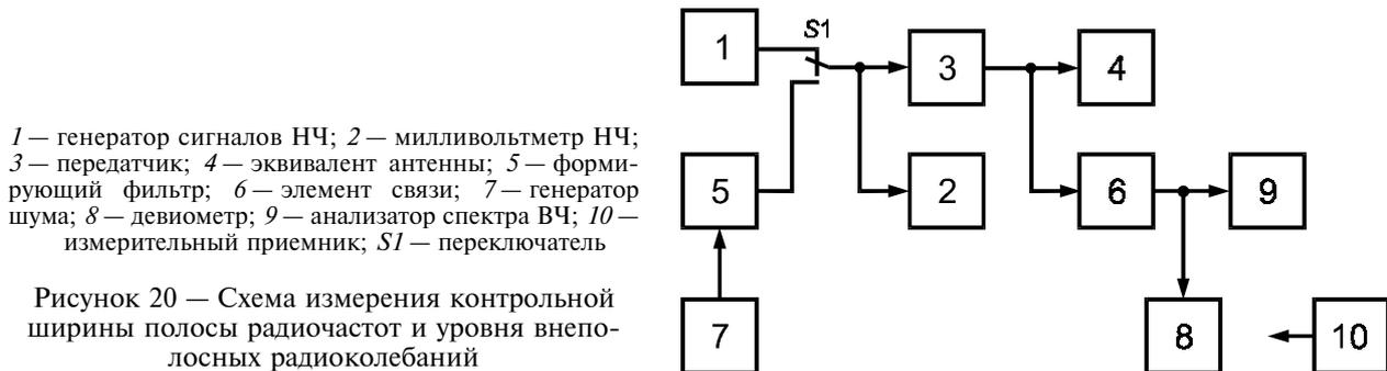
Рисунок 20 — Схема измерения контрольной ширины полосы радиочастот и уровня внеполосных радиоклебаний
