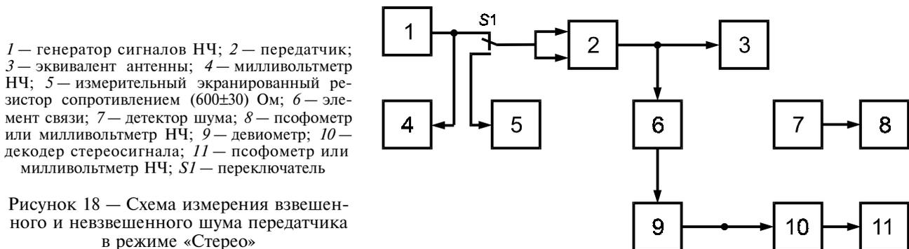
Рисунок 18 — Схема измерения взвешенного и невзвешенного шума передатчика в режиме «Сtereo»
