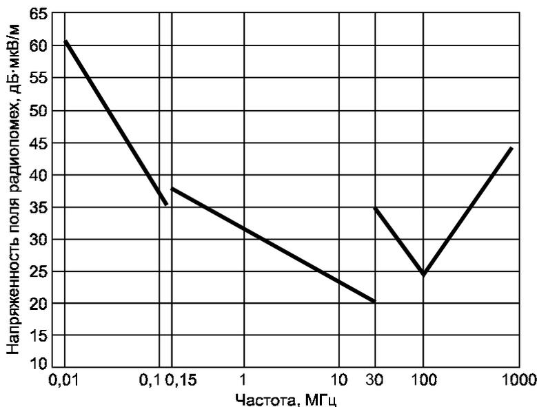
Рисунок 3 — Нормы напряженности поля радиопомех
