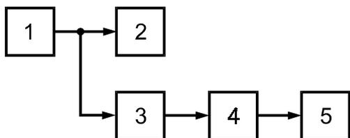
1 — передатчик; 2 — эквивалент антенны; 3 — элемент связи; 4 — девиометр; 5 — частотомер
