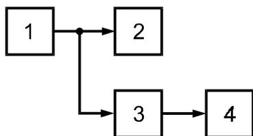
1 — передатчик; 2 — эквивалент антенны; 3 — элемент связи; 4 — девиометр
