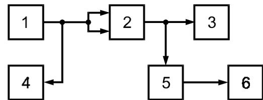
1 — генератор сигналов НЧ; 2 — передатчик; 3 — эквивалент антенны; 4 — милливольтметр НЧ; 5 — элемент связи; 6 — девиометр
