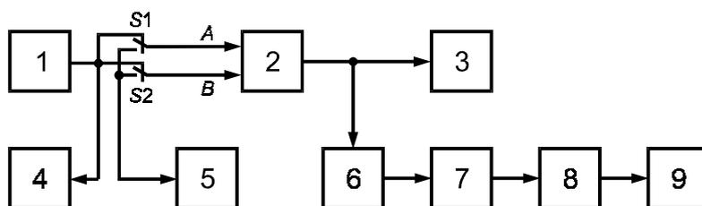
1 — генератор сигналов НЧ; 2 — передатчик; 3 — эквивалент антенны; 4 — милливольтметр НЧ; 5 — измерительный экранированный резистор сопротивлением  $(600 \pm 30)$  Ом; 6 — элемент связи; 7 — девиометр; 8 — декодер стереосигнала; 9 — ИНИ или анализатор спектра НЧ; S1, S2 — переключатели
