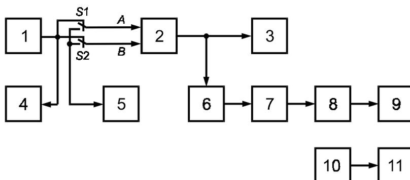
1 — генератор сигналов НЧ; 2 — передатчик; 3 — эквивалент антенны; 4 — милливольтметр НЧ; 5 — измерительный экранированный резистор сопротивлением  $(600 \pm 30)$  Ом; 6 — элемент связи; 7 — девиометр; 8 — декодер стереосигнала; 9 — анализатор спектра НЧ; 10 — корректирующий фильтр; 11 — осциллограф; S1, S2 — переключатели
