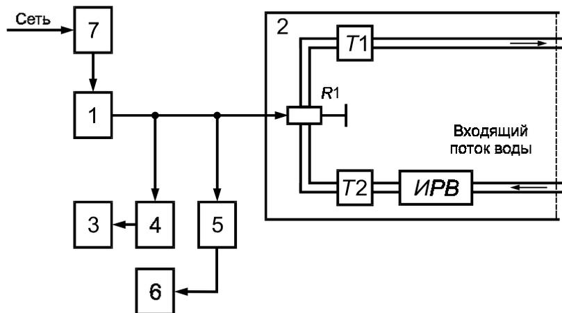
1 — передатчик; 2 — эквивалент антенны;  $R1$  — водоохлаждаемый согласованный резистор;  $T1$ ,  $T2$  — термометры воды на выходе и входе системы охлаждения; ИРВ — измеритель расхода воды; 3 — частотомер; 4 — элемент связи; 5 — аттенюатор; 6 — вольтметр ВЧ; 7 — ваттварметр
