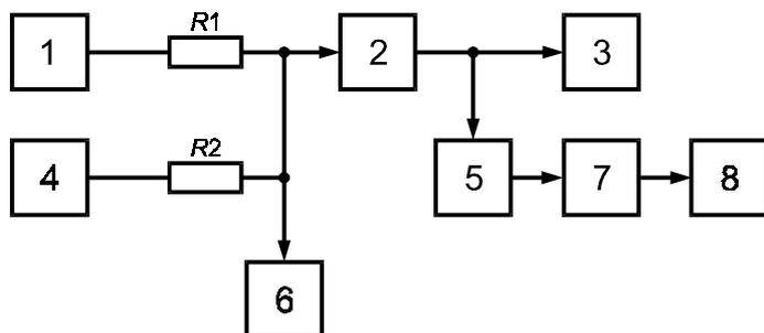
1 — генератор сигналов НЧ; 2 — передатчик; 3 — эквивалент антенны; 4 — генератор сигналов НЧ; 5 — элемент связи; 6 — милливольтметр НЧ; 7 — девиометр; 8 — анализатор спектра НЧ;  $R1, R2$  — резисторы сопротивлением  $(5,1 \pm 0,25)$  кОм
